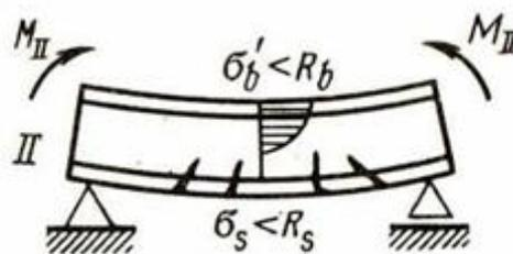
Достижение расчётных сопротивлений бетона и арматуры
