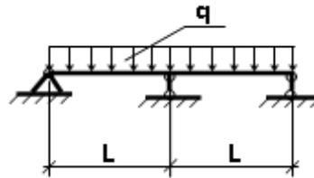
Двухпролётная разрезная балка
