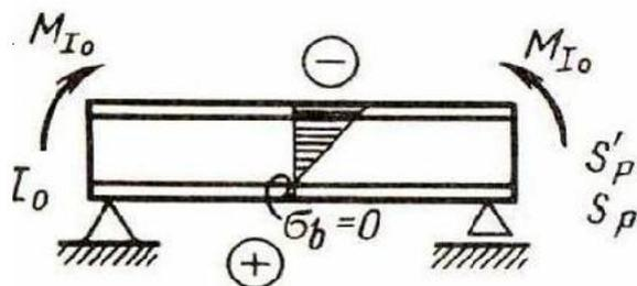
Образование трещин в растянутой зоне
