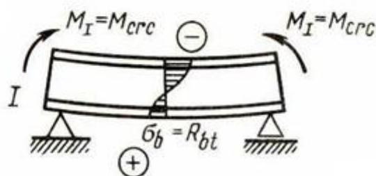
Работа с трещинами в растянутой зоне
